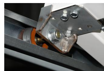
Les deux galets bas sont équipés d'un **système pare-chute**.
