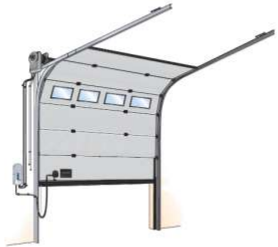
Figure 1 : porte sectionnelle motorisée
