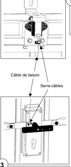
Une fois la mise en place du câble effectuée comme ci-dessus, contrôler le réglage de celui-ci : Lors de l'action de la poignée à l'ouverture, le pêne doit d'être tiré tout en conservant une garde afin de ne pas contraindre le mécanisme à chaque ouverture.
