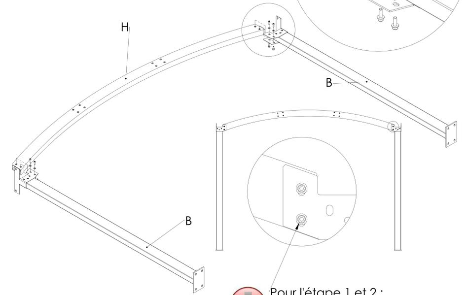
Pour l'étape 1 et 2 : Positionner l'arceau en haut des trous oblongs et serrer les vis à la main
