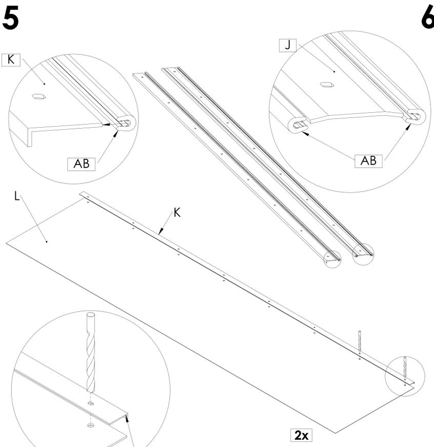
**!** Utiliser la fixation polycarbonate extrémité (K) comme gabari pour percer 2 plaques de polycarbonate. Percer 2 plaques au foret  $\phi 6$  puis  $\phi 10$ . Monter ces 2 plaques aux extrémités du carport.
