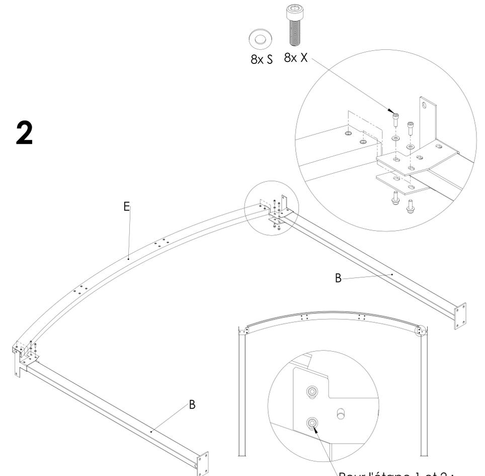
⚠ Pour l'étape 1 et 2 : Positionner l'arceau en haut des trous oblongs et serrer les vis à la main
