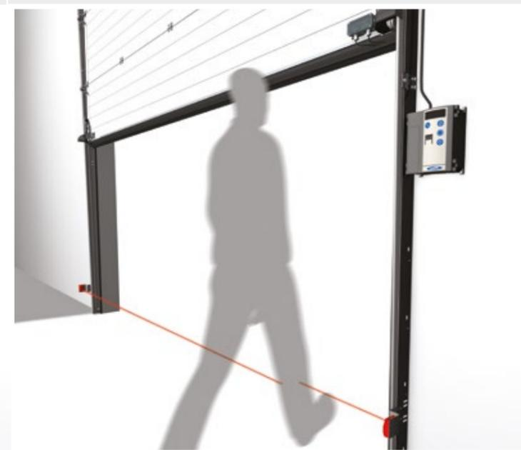
d'en face est monté un réflecteur ou un récepteur. Si le rayon entre l'émetteur et le réflecteur/récepteur est interrompu par un objet, un signal est donné au moteur afin d'inverser immédiatement le mouvement de la porte. Le système à réflecteur est toutefois plus sensible aux poussières et à l'humidité, contrairement à la version avec récepteur.
