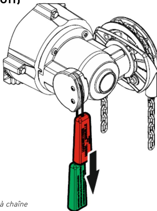
*Illustration 12 - Schéma détaillé du système de déverrouillage à chaîne*
