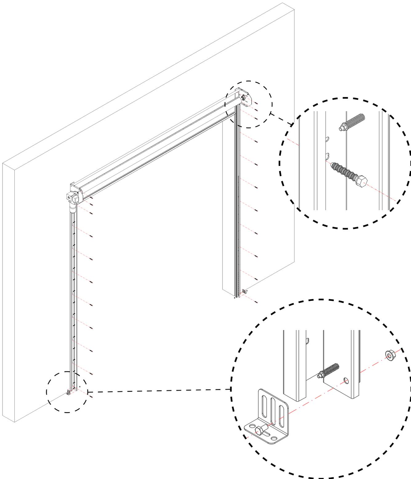
Illustration 7 - Fixation de l'ensemble au mur et au sol
