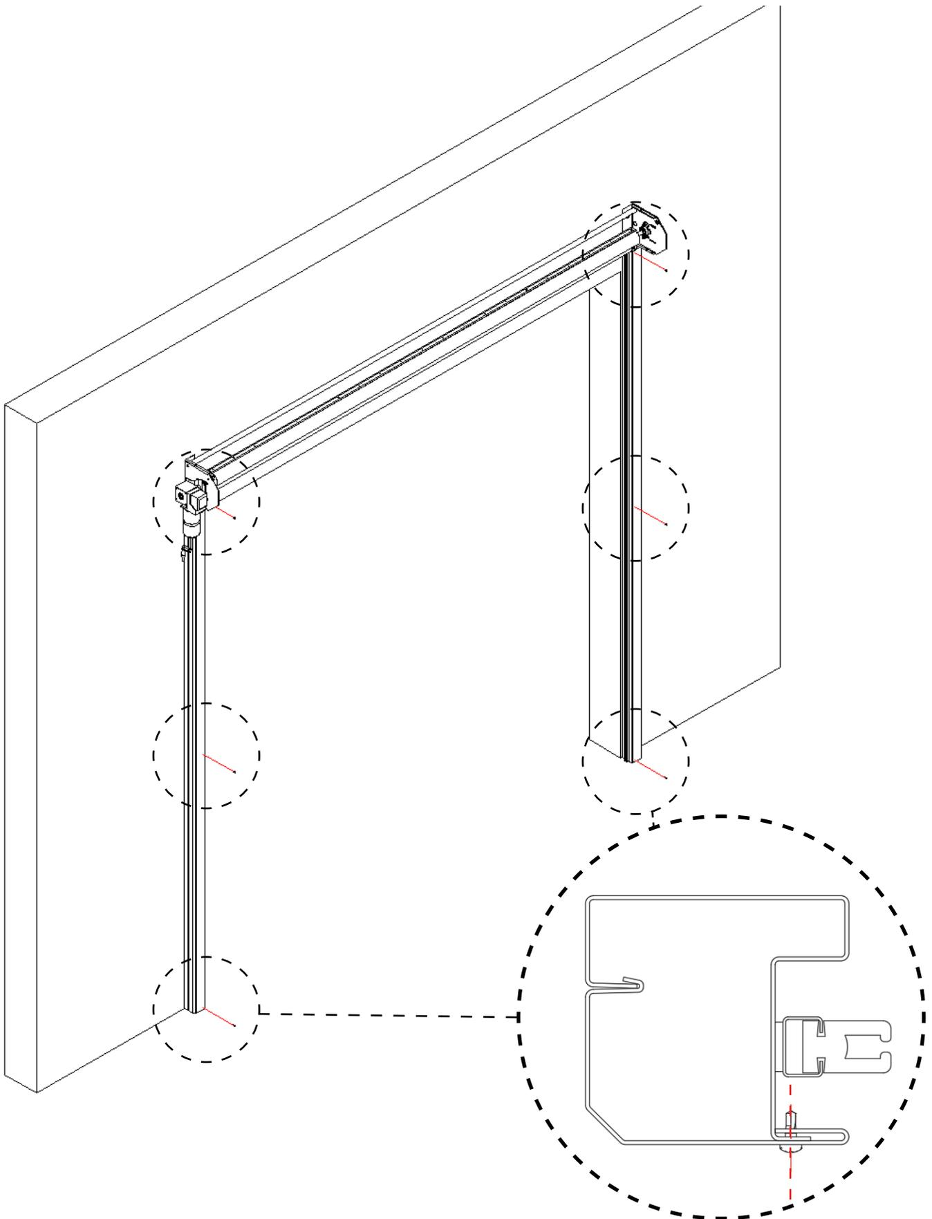
Illustration 8 - Fixation de la partie extérieure des montants latéraux
