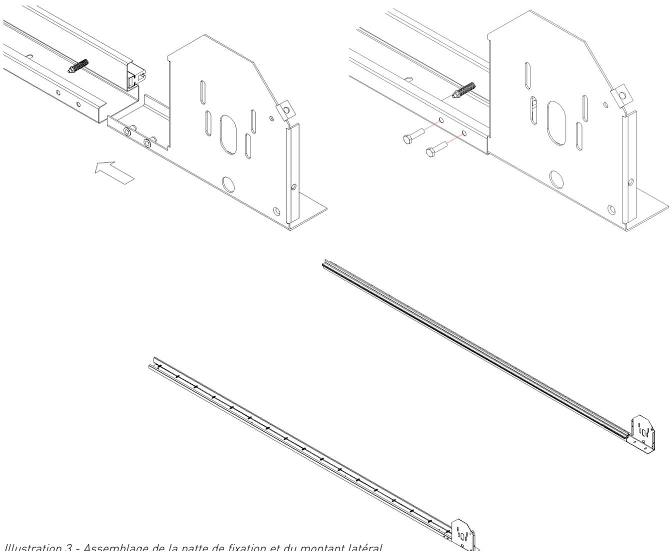
Illustration 3 - Assemblage de la patte de fixation et du montant latéral
