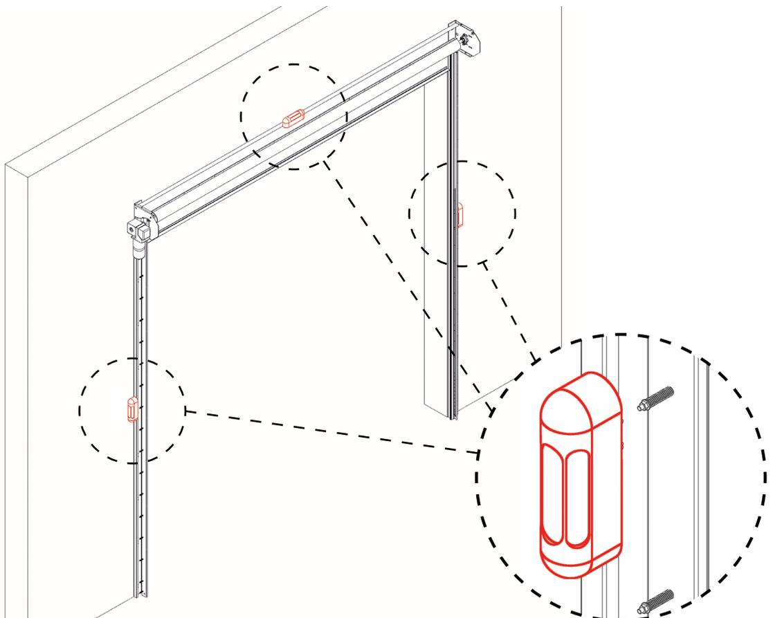
Illustration 6 - Mise à niveau et mise d'aplomb des montants latéraux équipés des pattes de fixation
