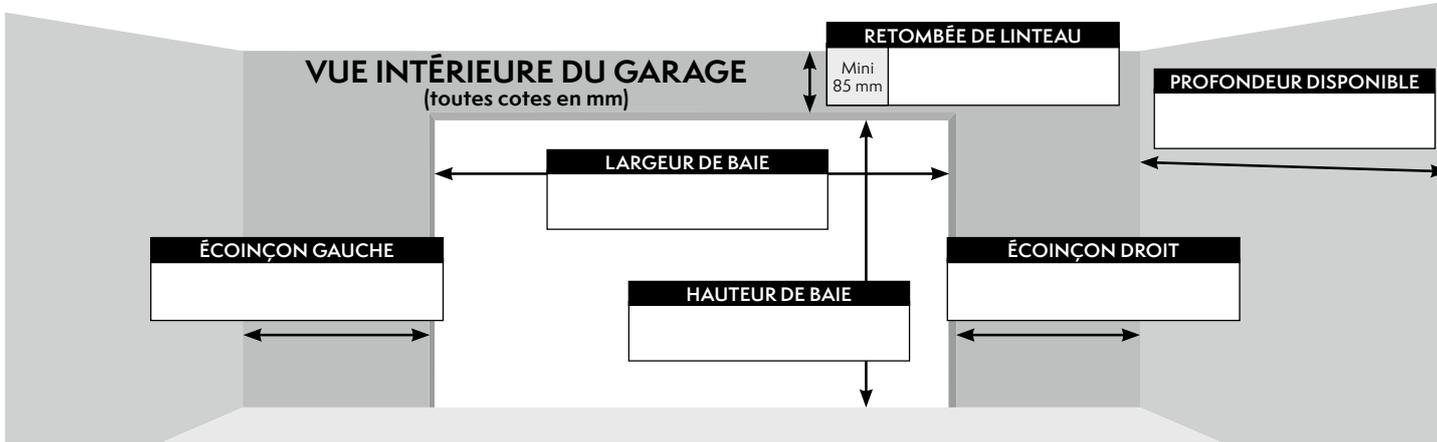
Type de pose : Applique Intérieur Tunnel . Sens d'ouverture : Vers l'intérieur
